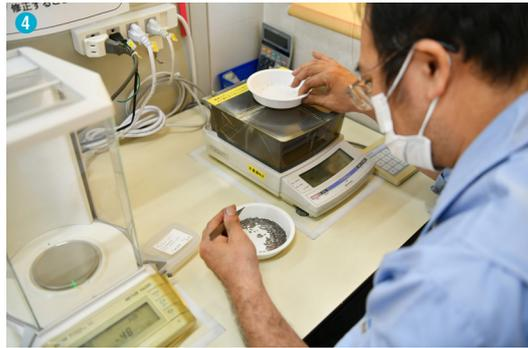
①ピンを削るのに使われる切削機械 ②モニターに拡大した映像を見ながら検査をおこなう ③半導体検査装置などに使用されるプローブピン ④1本1本数えるのが困難なため計量したうえで必要な本数を納品する
